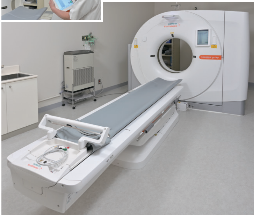
寝台のストロークは2000mmを有しながら、装置全体のコンパクトさを維持。現病院が開設された当時(1996年)にシングルスライスヘリカルCT装置が稼働していた約24㎡の検査室にも、設置が可能である。
