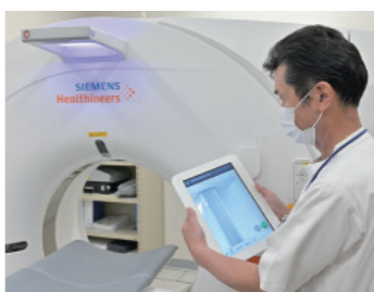
着脱可能なタブレット端末を用いることで、患者登録から条件設定、セッティング、撮影、画像確認および画像データの転送など、一連のCTに関する操作を検査室内で行うことができる(写真は上下共「SOMATOM go.Top」)。
